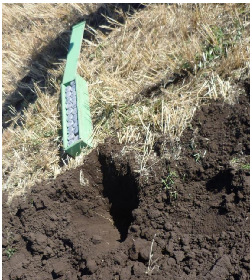
Рисунок 3.9 – Определение влажности обрабатываемого слоя почвы после обработки пахотным агрегатом с навесным секционным плугом ПБС-16-38
