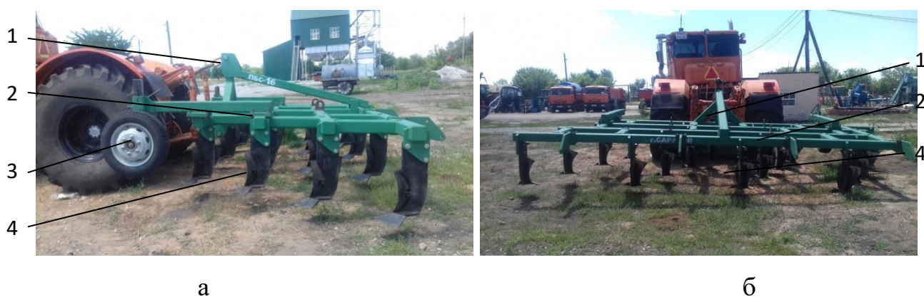
Рисунок 3.1 – Экспериментальный секционный лемешно-отвальный плуг ПБС-16-38 с изменяемой шириной захвата в агрегате с трактором К-701 (а- вид сбоку; б- вид сзади):
