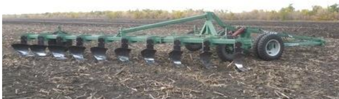
Рисунок 1.17 – Прицепной отвальный плуг ПБС-10П
