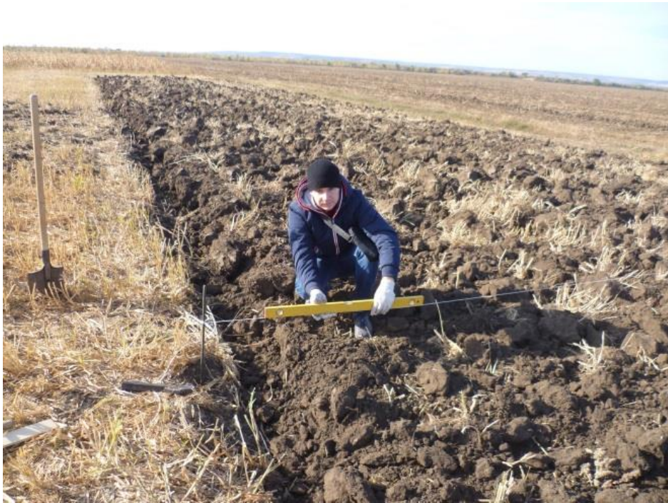
Рисунок 3.11 – Проверка горизонтальности установки нити с помощью строительного уровня
