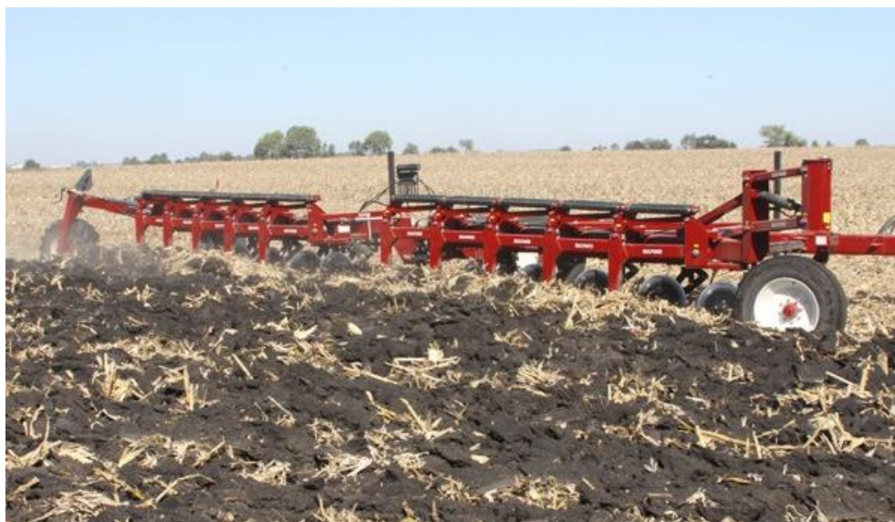
Рисунок 1.10 - Канадский прицепной плуг Salford 8214
