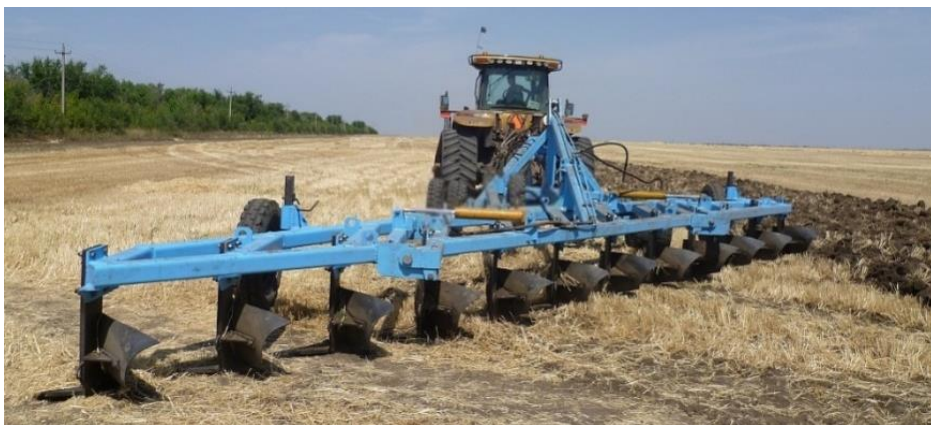
Рисунок 1.18–Прицепной отвальный плуг ПБС-12П
