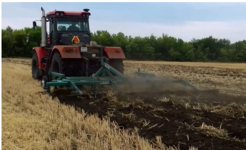
Рисунок 4.2 – К-744Р4+ПБС-16-38 при выполнении работы
