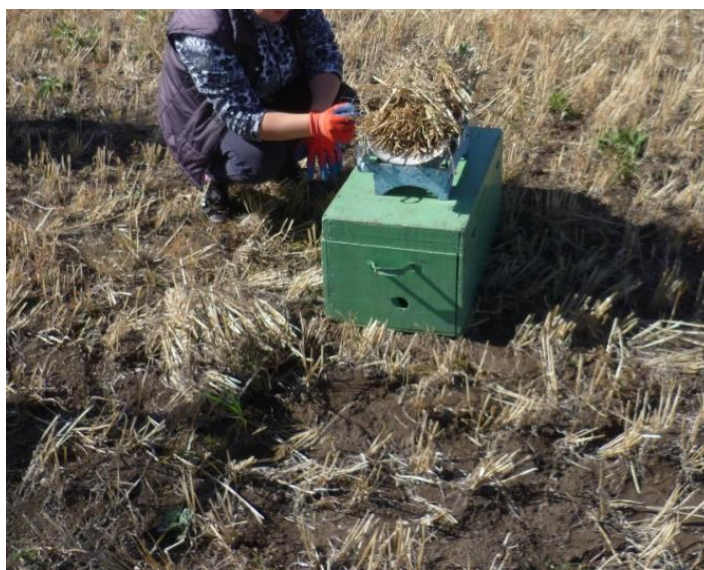
Рисунок 3.13 – Измерение массы растительных остатков
