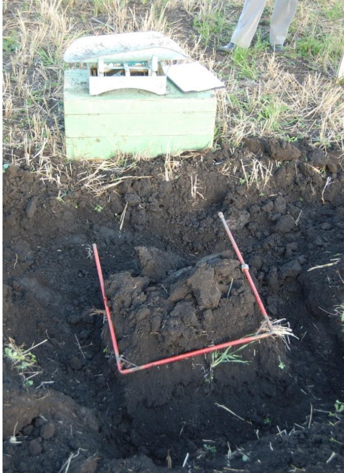
3.14 – Определение крошения обрабатываемого слоя почвы
