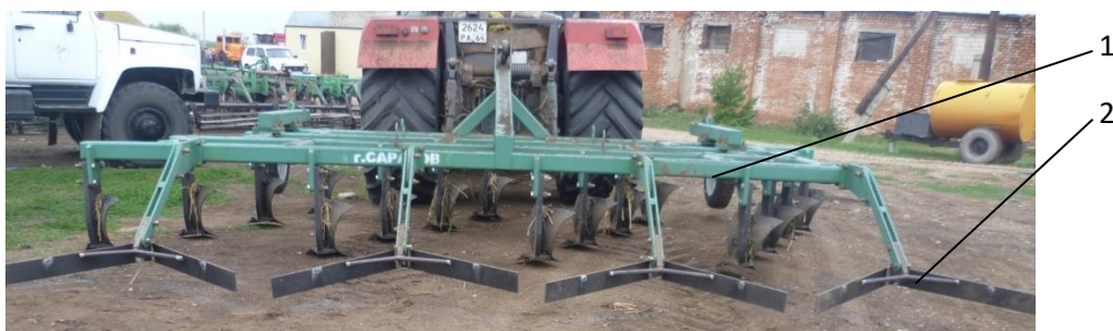
Рисунок 3.7 – Плуг ПБС-16-38 с приспособлениями №2 для выравнивания поверхности пашни: 1 – рама плуга ПБС-16-38; 2 – сталкиватель
