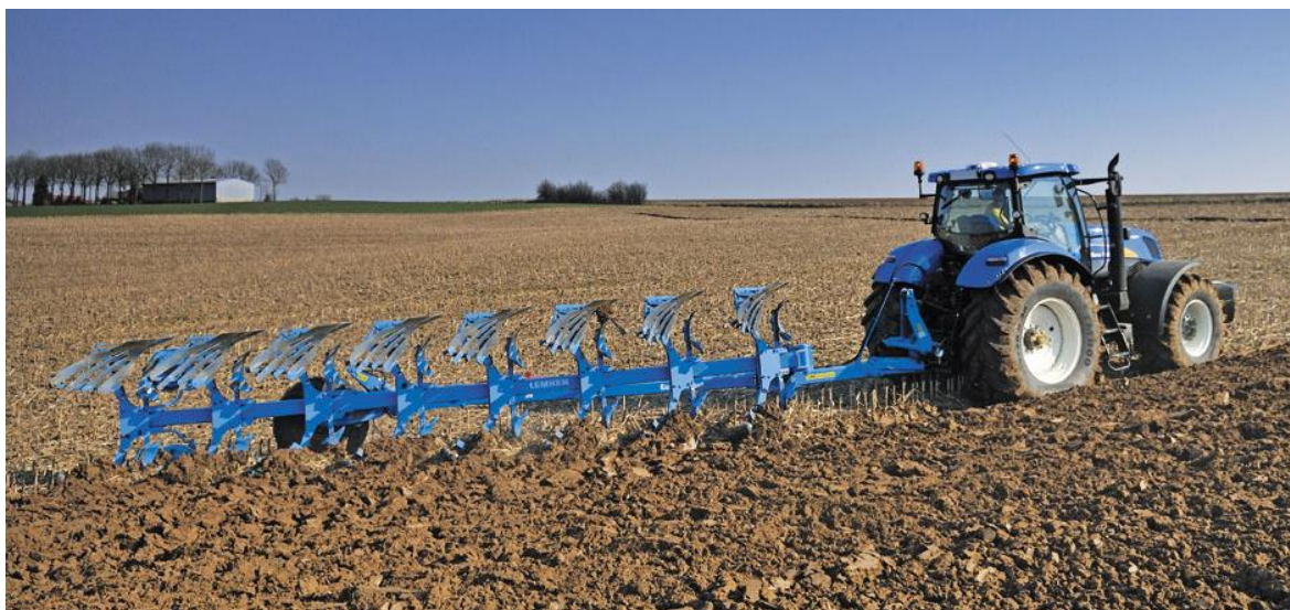
Рисунок 1.12 – Общий вид полунавесного оборотного плуга EuroDiamant 10 7+1 L100
