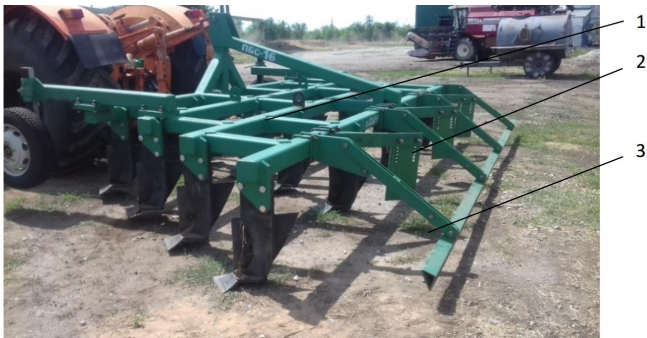
Рисунок 3.4 – Плуг ПБС-16-38 с приспособлениями № 1 для выравнивания поверхности пашни: 1 – рама плуга ПБС-16-38; 2 – сталкиватель; 3 – выравниватель
