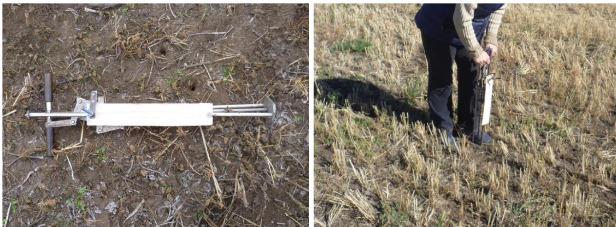
Рисунок 3.10- твердомер Ревякина (А) и измерение твердости почвы (Б) твердомером Ревякина
