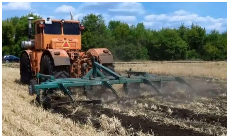
Рисунок 4.1 – К-701+ПБС-16-38 при выполнении работы
